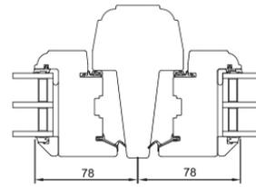
V2 A: Mittlerer Anschlag mit Pfosten
